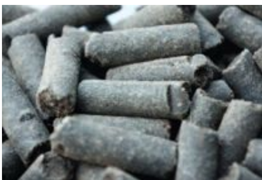
Une fois séchées, les boues fécales sont transformées en combustible, par exemple sous la forme de pellets, puis vendues à l'industrie.
